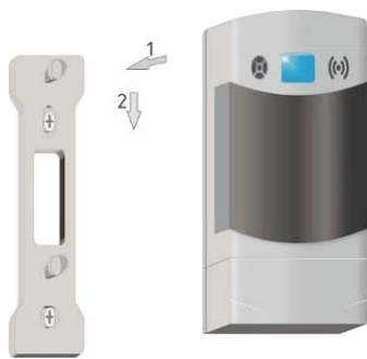
Рисунок Д.3 – Установка сигнализатора на монтажную панель
